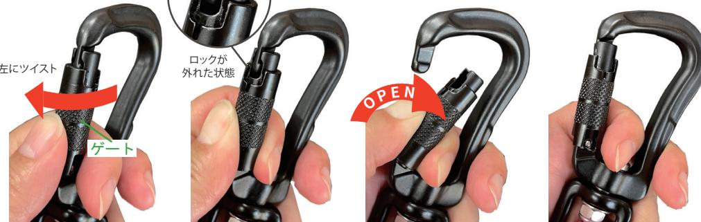
カラビナのゲート部分を左に回し、外側を押すと開いた状態になり、手を離すと自動的にロックされた状態で閉まります。
